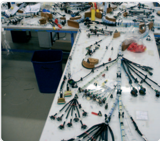
→ Fabrication harnais Falcon 7X à Liposthey
