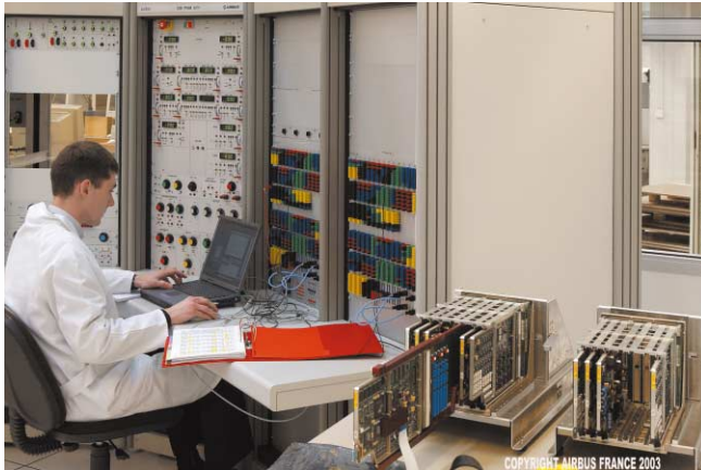
Banc d'intégration système A380
