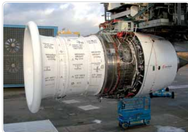
→ Exemple d'instrumentation moteur Trent 900 → Example of Trent 900 engine instrumentation
